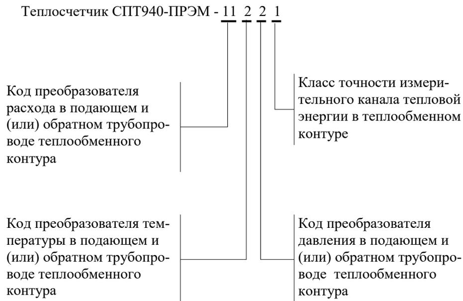
Рисунок 2.1 – Структура обозначения теплосчетчиков
