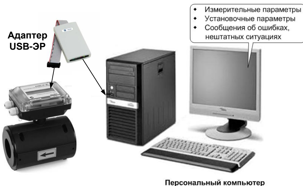
Рис.1. Средства управления расходомером ВЗЛЕТ ЭР.
