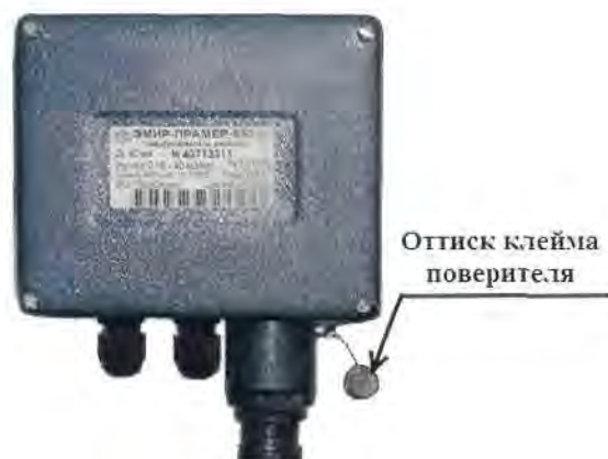
Рисунок 3 – Место пломбирования ЭП в стальном корпусе
