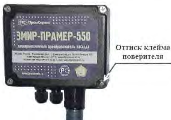
Рисунок 4 – Место пломбирования ЭП в пластиковом корпусе
