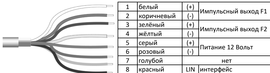
Рис. 3 Схема подключения расходомера с IP68
