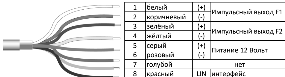
Рис. 3 Схема подключения расходомера с IP68
